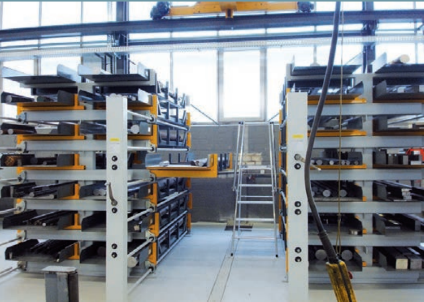
Bei Teleskop-Kragarmregalen werden ganze Lagerebenen mit einer Kurbel über drehbare Spindeln ausgefahren. Optimal für Kranhandling bei minimaler Gangbreite.
